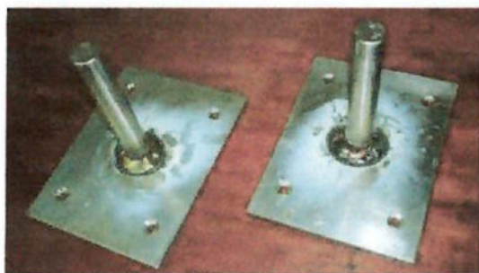
Figura 15 – Conjuntos de fixação após soldagem
