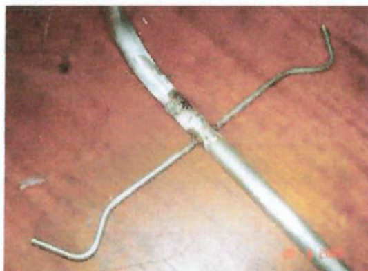
Figura 14 – Haste e ganchos após soldagem
