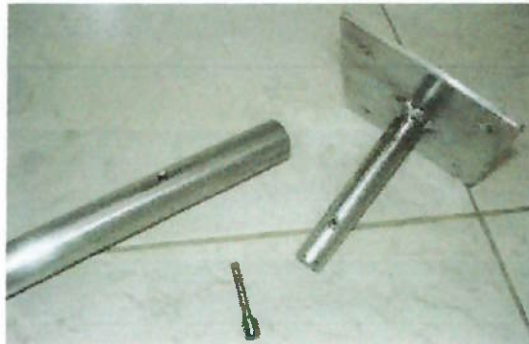
Figura 17 – Furos para encaixe do pino
